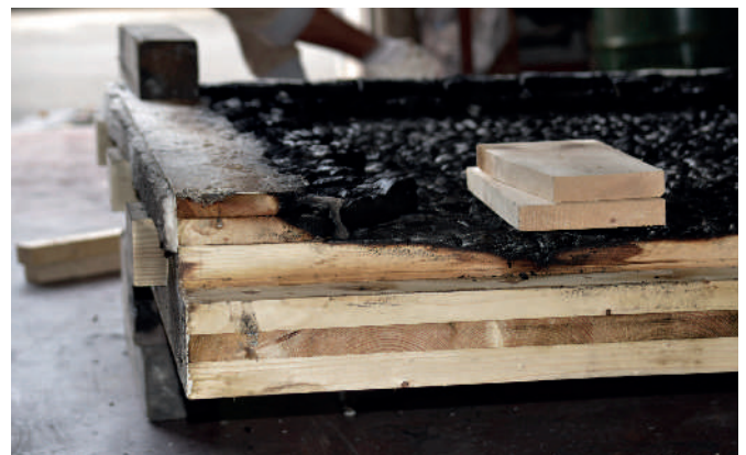
Beflammung mit 1.000 °C: nur wenige Zentimeter Abbrand.
